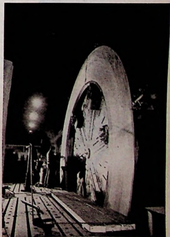
Het afdraaien van een 11 cm. dikke stalen flens, met een middellijn van 8 meter.
